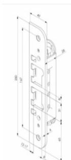
Регулирование осуществляется с помощью двух винтов на передней стороне запорной планки шаг регулировки 5мм. закрывается и запирается. Такой же как LP711 (смотрите выше), только с двумя отверстиями.
